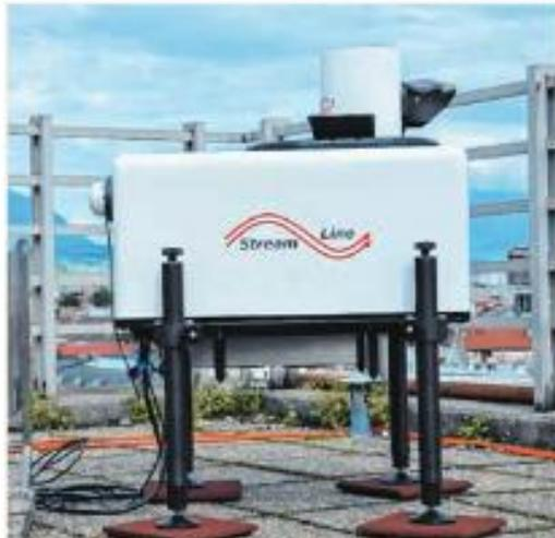
Mit Lasereinstrumenten am Boden (li., hier auf dem Dach des Bruno-Sander-Hauses der Uni Innsbruck am Innrain in Innsbruck) und einem Flugzeug (re., hier am Flughafen Innsbruck) messen die Forscher die turbulenten Föhnwinde über dem Inntal.
